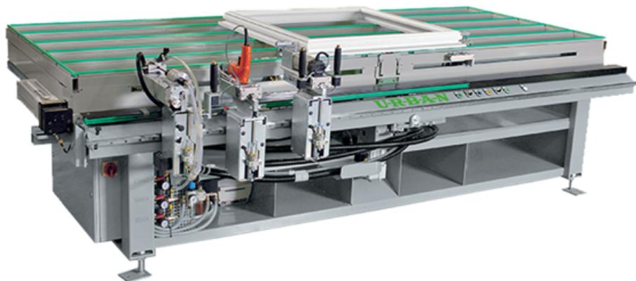
L'Urban FAS 320 est une table de montage flexible et de haute qualité pour le montage de quincaillerie en PVC dans des battants (pièces tournantes). La table comprend un système automatique de centrage et de clamage : le battant est serré des deux côtés afin qu'il ne puisse pas glisser pendant le vissage. L'unité de vissage extrêmement stable se déplace sur un guide linéaire, dispose d'une alimentation de vis automatique et est
