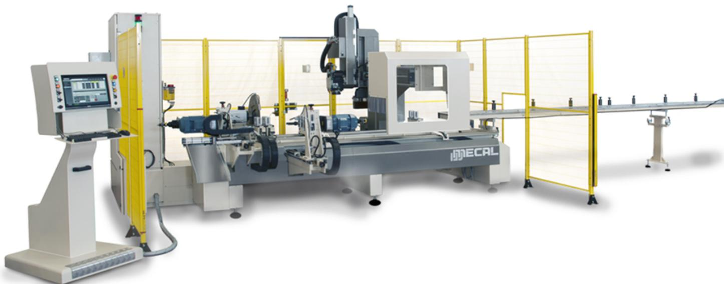
Le Mecal FMM 311 est un centre d'usinage CNC à 4 axes avec module de sciage permettant d'usiner et de couper des profilés en aluminium et en PVC.
