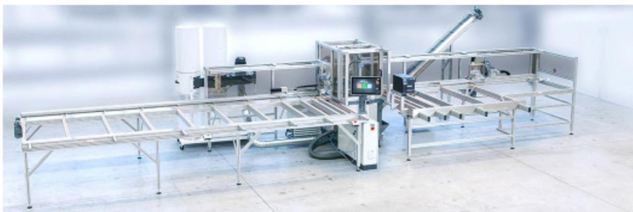
Le Thorwesten ASZ est un centre de sciage CNC évolué pour la fabrication de portes et fenêtres en PVC. La machine peut être configurée comme une machine autonome ou combinée avec un ou plusieurs centres de sciage ASZ en forme de U ou en disposition linéaire. En outre, l'ASZ peut également être combiné avec le PBZ-4 (ASZ + PBZ = MPZ).
