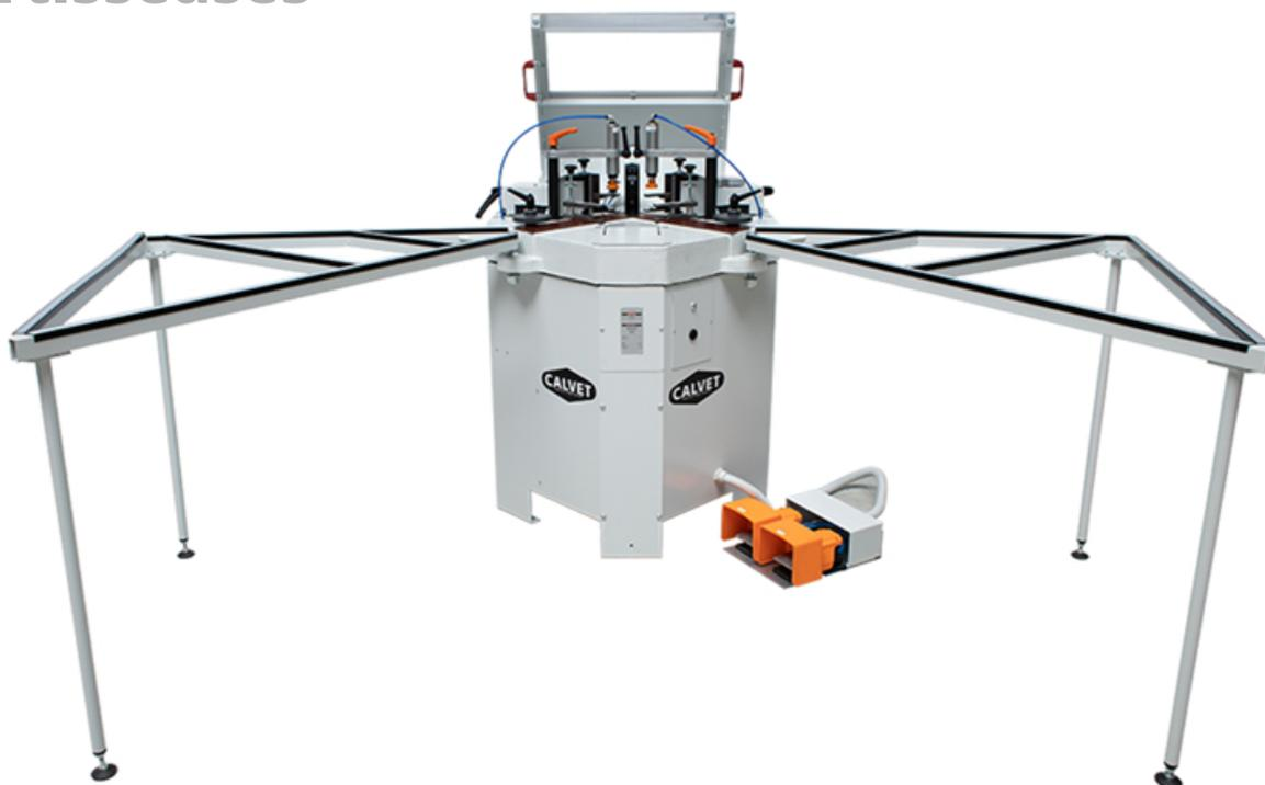
L'Atla Coop JOLLY une sertisseuse pour la jonction des profilés aluminium dans la fabrication de fenêtres et portes. Le sertissage est pneumatique avec une transmission mécanique. Il est possible de sertir des profilés d'une section maximale de 120 x 100 mm (Hxl) La hauteur maximale de sertissage est de 115 mm.
