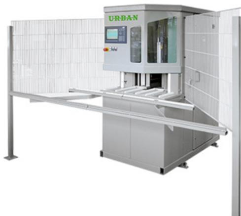
L'Urban SV 410-B est une ébavureuses à 2 axes et 1 tête. Cette ébavureuses à commande numérique a une construction très robuste et est idéale pour une utilisation en tant que machine autonome grâce à sa taille compacte. L'opérateur peut sélectionner un programme manuellement ou la machine peut le sélectionner automatiquement grâce à la reconnaissance des profils.
