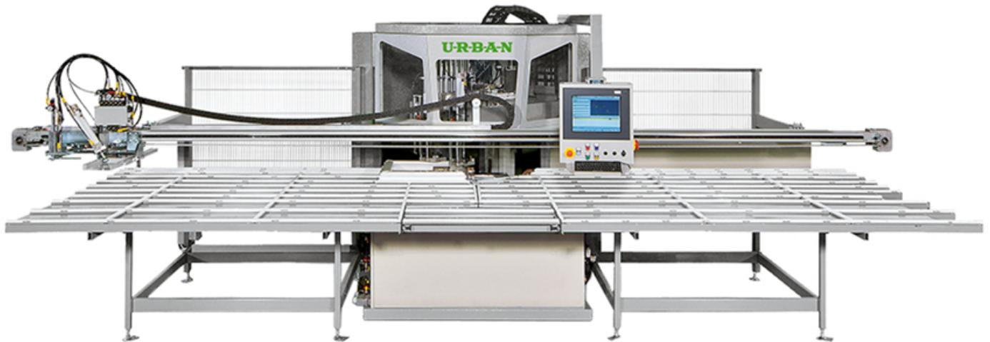
L'Urban SV 530 est une ébavureuse à 2/4 axes et 1 tête. Elle est la plus rapide du marché. Grâce à la tête mobile et aux outils au-dessus et en dessous qui fonctionnent indépendamment, les dormants/ouvrants sont ébavurés en moins de 100 s. De conception très robuste, la machine peut être placée en toute facilité entre une machine à souder à 4 têtes et un système de désempilage (simple).
