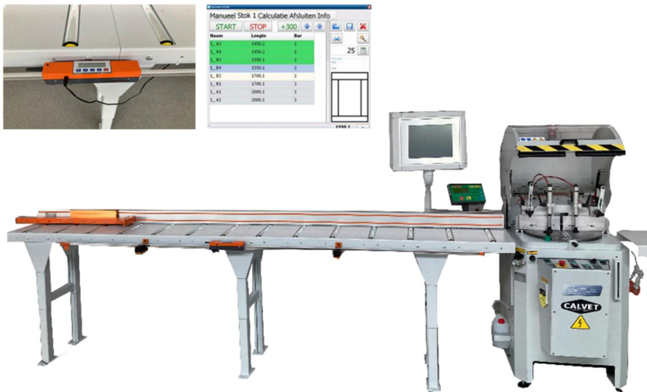
Le Tigerstop est un système automatique de poussée et de butée longitudinale qui s'intègre parfaitement à votre machine neuve ou existante. Avec un TigerStop, vous êtes assuré de disposer d'une machine conviviale et précise qui accélérera votre production.
