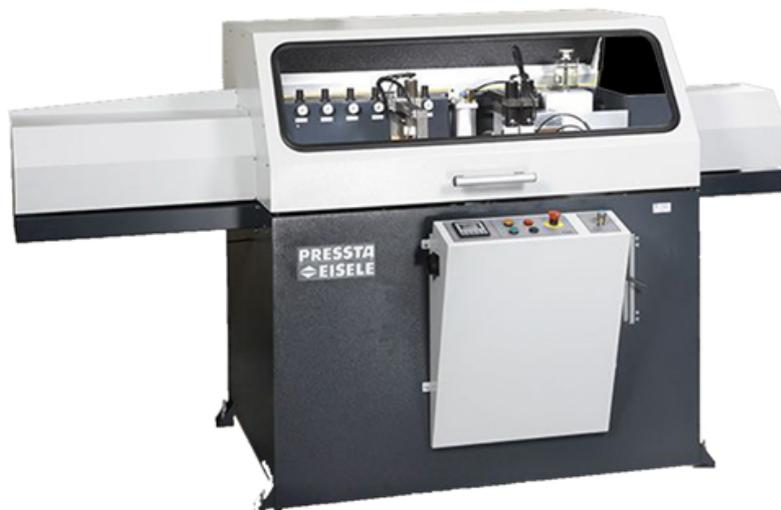
La Presta Profilma 501E est une scie entièrement automatisée avec une lame ascendante. L'alimentation de la lame de scie est hydropneumatique et peut être réglée en continu à la hauteur de sciage nécessaire. La machine dispose d'une alimentation pneumatique et convient pour les profilés d'une longueur allant jusqu'à 6 m.
