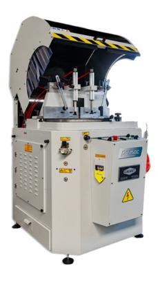
La Pemac SA 400 est une tronçonneuse à une tête avec un mouvement de sciage automatique ascendant au moyen d'une commande à deux mains. La machine est équipée d'une table de travail pivotante avec un réglage d'angle de -22,5° à +135°.
