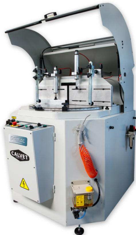
La Pemac SA 500 est une tronçonneuse à une tête avec un mouvement de sciage automatique ascendant au moyen d'une commande à deux mains. La machine est équipée d'une table de travail pivotante avec un réglage d'angle de -22,5° à +135°.
