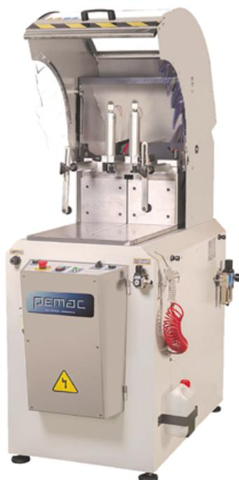
La Pemac SF 600 est une tronçonneuse à 1 tête avec une lame de scie ascendante. La machine présente une construction stable et convient parfaitement pour scier de grands profilés en aluminium à 90°. Cette machine se décline dans différents diamètres de la lame.
